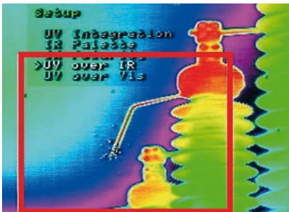
Abb. 39: Überlagertes Bild von IR- und Korona-Messung derselben Durchführung
