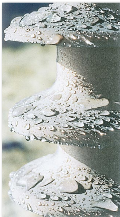
Abb. 10.2: Hydrophobe Wirkung einer Silikonoberfläche mit Industrierverschmutzung
