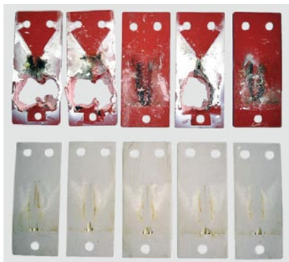
Abb. 9: Erosionsverhalten von nicht gefülltem (obere Reihe) und optimiert angereichertem Silikongummi (untere Reihe)
