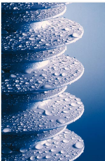
Abb. 10.1: Hydrophobe Wirkung einer Silikonoberfläche ohne Verschmutzung
