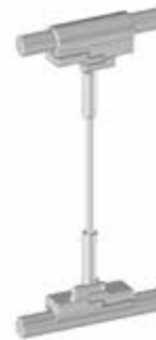
Conductive monobloc dropper Pendule monobloc conducteur
